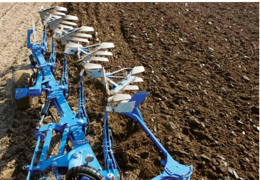
Dobar kvalitet oranja u velikoj meri zavisi od širine radnog zahvata i radne dubine pojedinačnih plužnih tela. LEMKEN-ov Juwel M V na najbolji način može da ispuni zahteve za obradu zemljišta oranjem.
