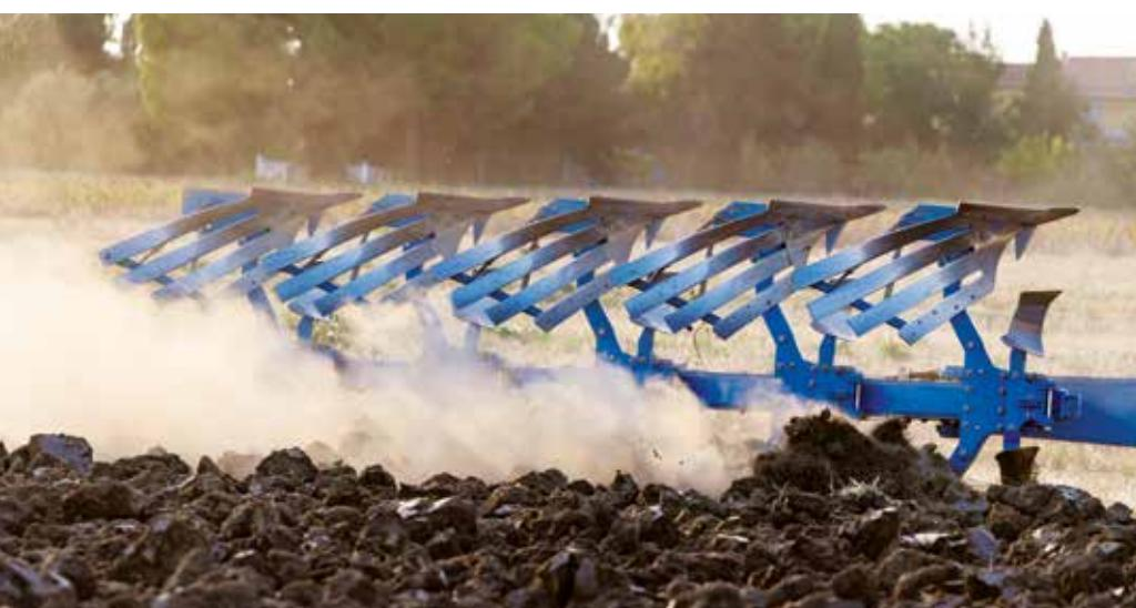
Greda pluga dimenzija 160 x160 x 10 mm i osovina za obrtanje sa prečnikom od 130 mm.
